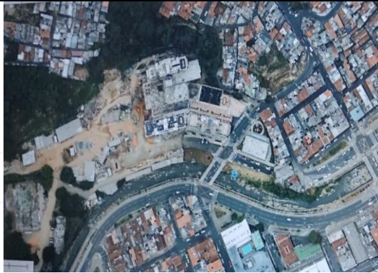
Detalle de Ortofoto mosaico RGB+NIR con un pixel de 8 cm, resultado del procesamiento fotogramétrico de las 369 fotografías aéreas.
